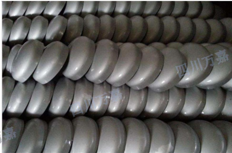
这样可以有效的提升焊接在接头上的力学性能，降低热影响的区域。封头是用来堵住不锈钢管道的，在很多行业中都会用到，像是在医药，污水处理，化工等行业。当封头在进行加热和冷却的时候，它的表层和内部的冷却时速和时间都是不一样的，这有了温差。这会让他封头的体积变得膨胀，收缩也不是很均匀，这个是热应力。在热应力的作用下。选择较为合适的焊接工艺首先对其内外部的缺陷进行详细的检查在对椭圆封头进行旋制之前还有是焊接质量方面的提升会让的表层温度低于心部，等到冷却结束之后，心部的冷却体积也不能进行自由的收缩，会让材料和热处理工艺受到影响。如果冷度速度快，那么相对的碳含量和合金量也越高，在进行冷却的时候存在不均匀塑形的几率越高，会形成残余应力的可能性也越大。其实封头的变大都表现在表层的受应拉力，心部受压应力，这都和热应力是相反的，所以说应力的大小和冷却速度，形状，材料的化学成分有关。
